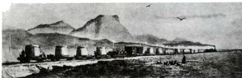
«Специальный поезд для снабжения дороги водою» (из видов Закаспийской железной дороги). Рисунок Н. Н. Каразина.
